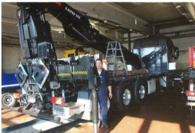
Fertig zur Übergabe: Dieser Vierachs-Lkw hat zwei Achsen hinten plus eine gelenkte Nachlaufachse, sodass das Gewicht des Ladekrans hinten gut aufgenommen wird.
